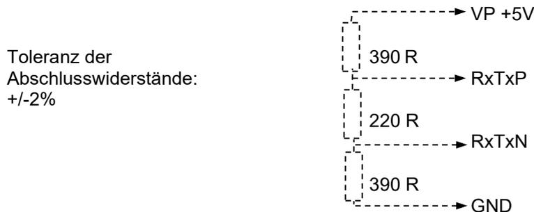
Die Abschlusswiderstände sind in den üblichen Profibus-Sub-D Steckern (abschaltbar) integriert.
