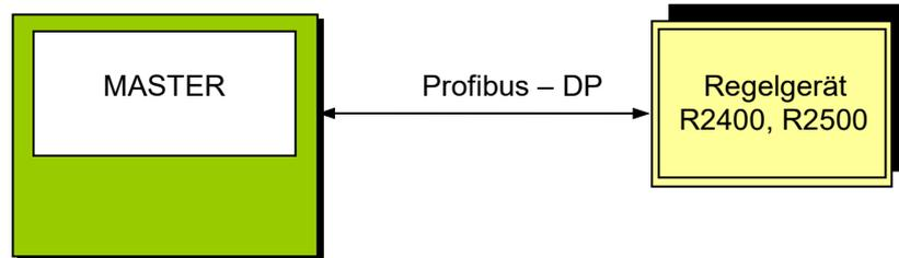
Es ist möglich, die Mehrzonentemperaturregler über Profibus-DP nach EN 50170 durch einen Master überwachen und steuern zu lassen.
